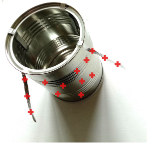
Obr. 1.2: Kúsky alobalu sú odťahované od plechovky v dôsledku rovnakého náboja.
