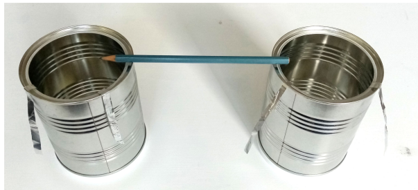
Obr. 1.4: Ak sú plechovky prepojené izolantom (ceruzkou z dreva), pri nabíjaní jednej plechovky sa druhá nenabije (pásiky z alobalu sa neodťahujú).
