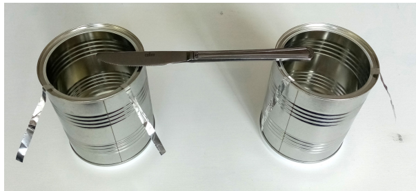
Obr. 1.3: Ak dve plechovky prepojíme vodičom (napr. kuchynským nožom), pri nabíjaní jednej sa nabije aj druhá (pásiky alobalu sa odťahujú od oboch plechoviek).
