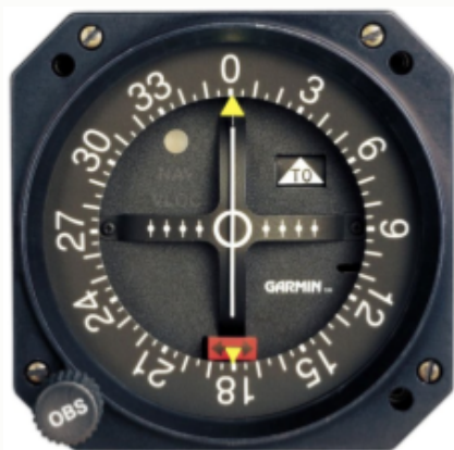
Wskaźnik zegarowy do radionawigacji VOR/DME (źródło: oficjalna strona Garmin)
